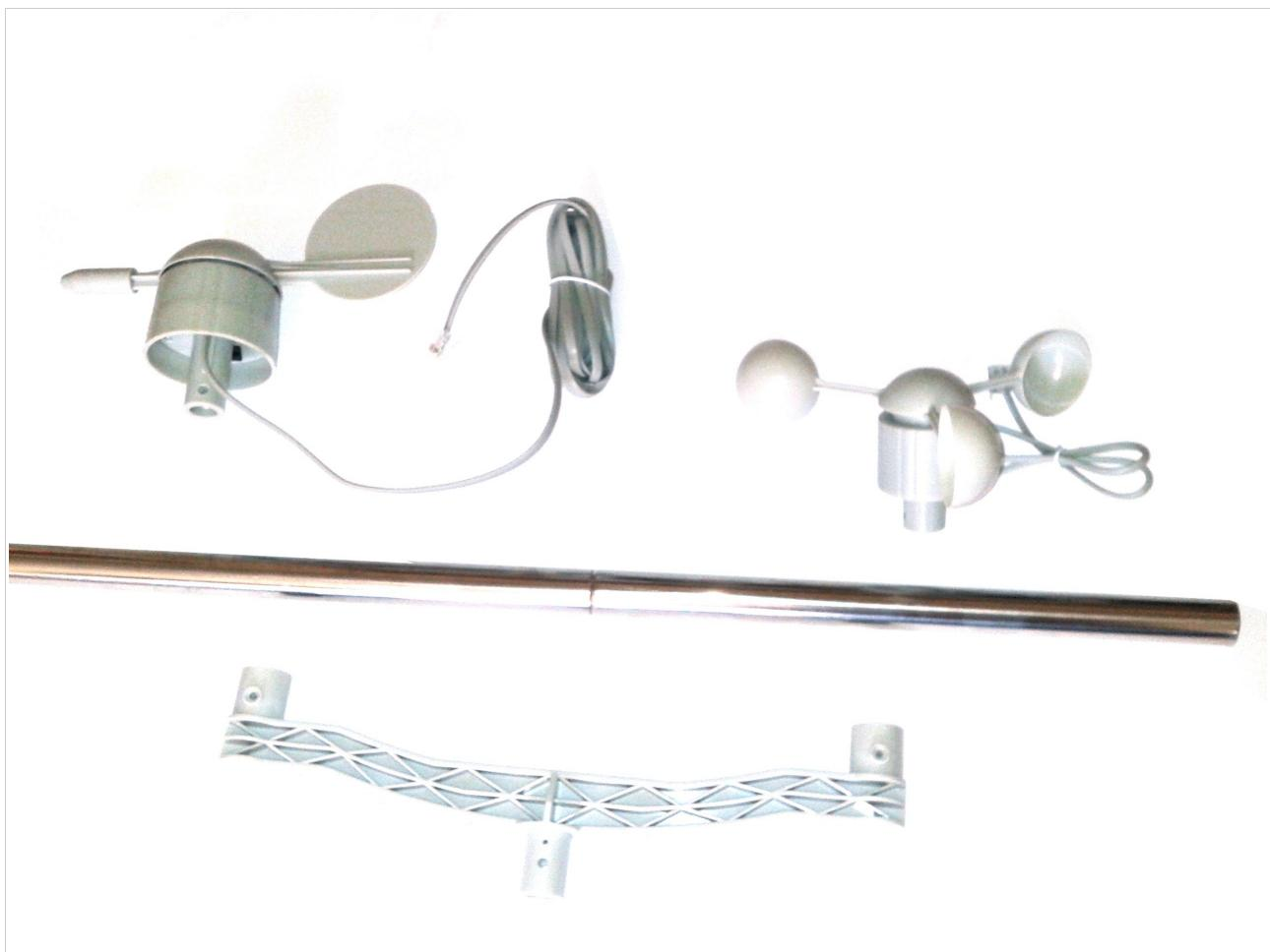
4. Inainte de a fixa suportul, mai intai trebuie sa montezi senzorii de vant. Montarea este simpla, tot ce trebuie sa faci este sa fixezi senzorii pe cele 2 brate si sa montezi surubul si piulita.
