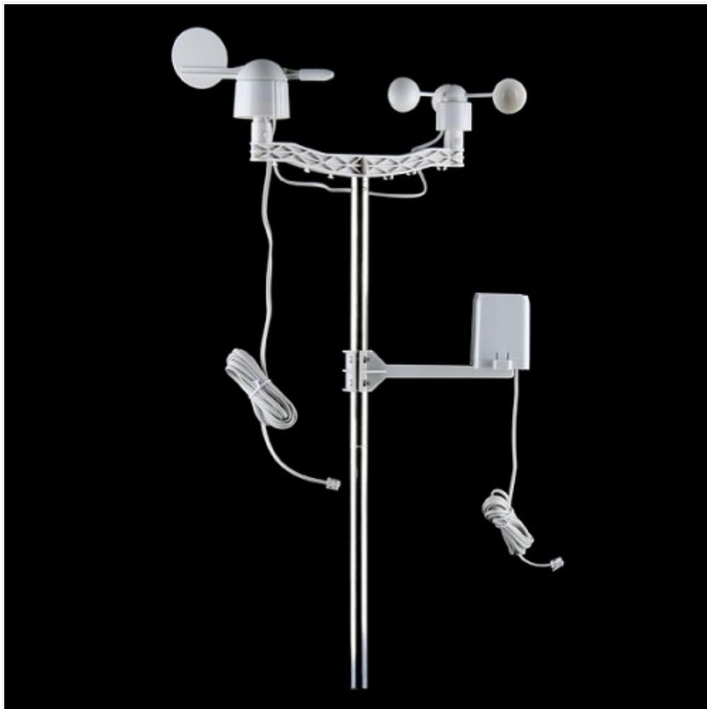
Statia meteo este capabila de a masura 3 parametrii importanți: viteza, directia vantului și cantitatea de precipitatii. Senzorii din aceasta statie sunt formati doar din switch-uri reed si magneti, ceea ce inseamna ca sunt foarte usor de utilizat, dar pentru a functiona acestia au nevoie de o sursa de alimentare.
