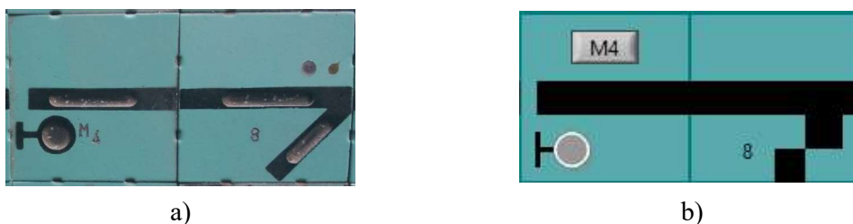
Figura 20. Aspectul unei secțiuni pe pupitrul domino (a) și în interfața electronică (b)
